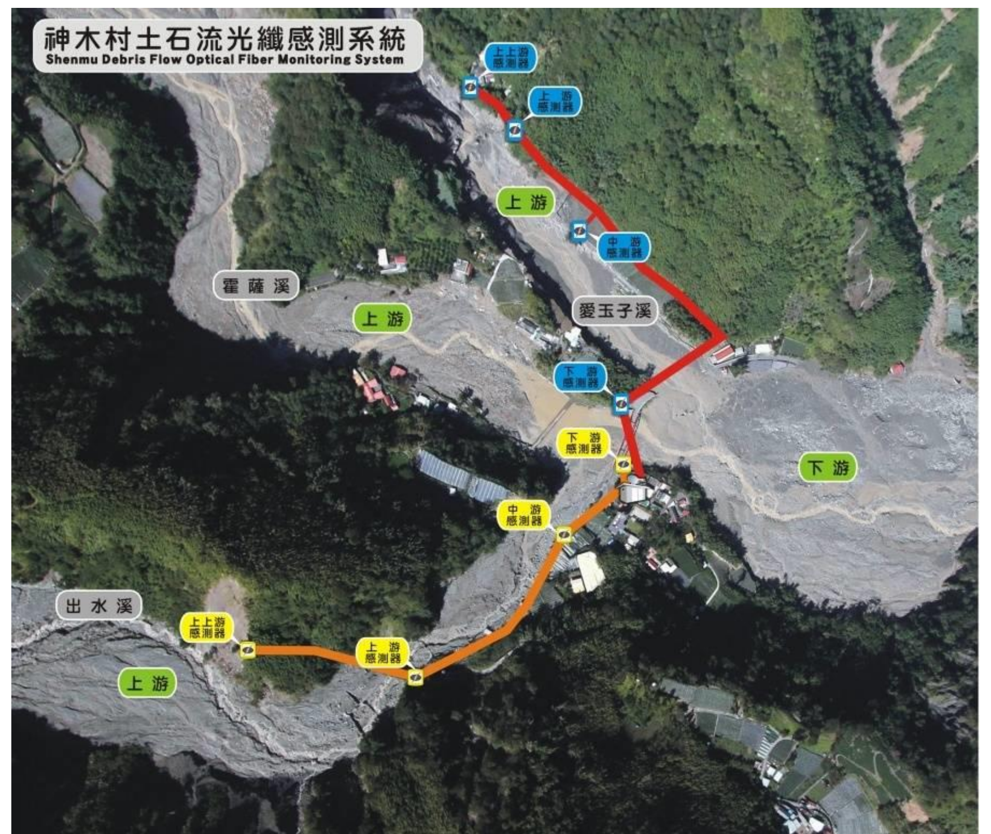
圖4 南投縣信義鄉神木村土石流光纖監測系統
