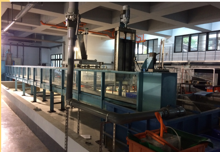
▲海工大樓新建河工試驗水槽
